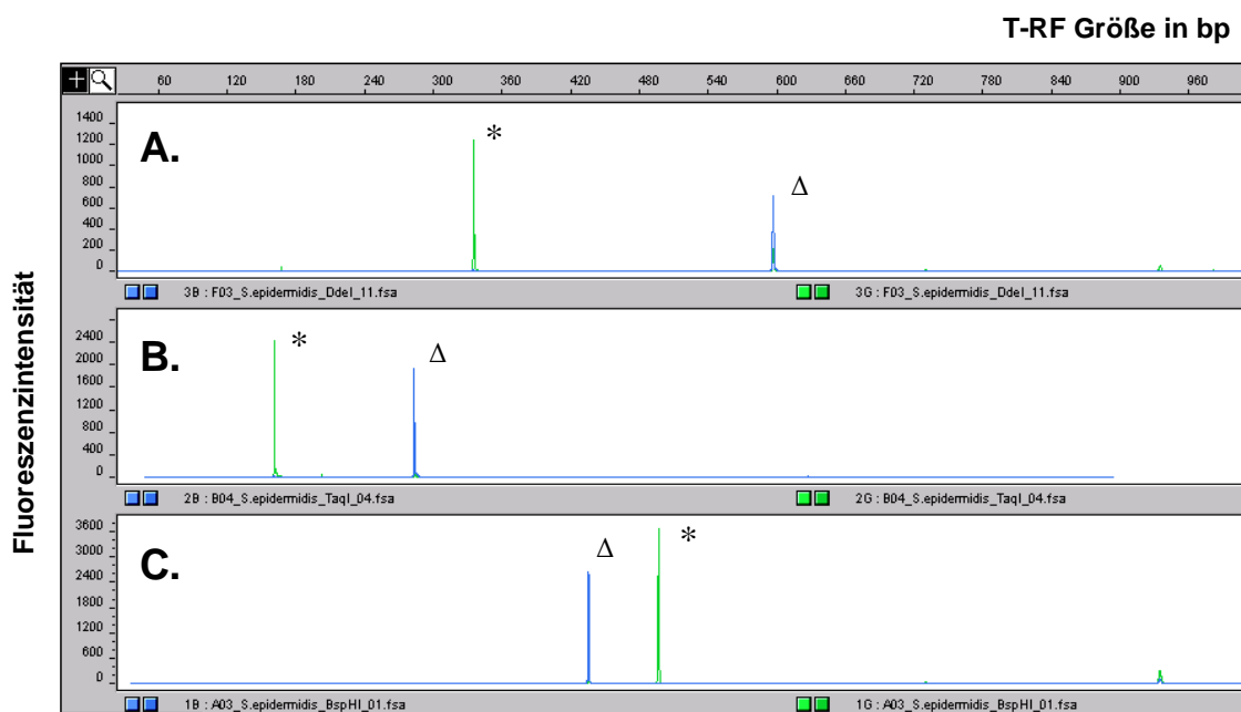
Abbildung 4.11: T-RFLP-Profil von S. epidermidis DSM 20044 nach Restriktion mit DdeI (A.), TaqI (B.) und BspHI (C.). Die x-Achse entspricht der Fragmentgröße in bp und die y-Achse zeigt die Fluoreszenzintensität in relativen Fluoreszenzeinheiten. (* HEX-markierte Fragmente; Δ FAM-markierte Fragmente)
