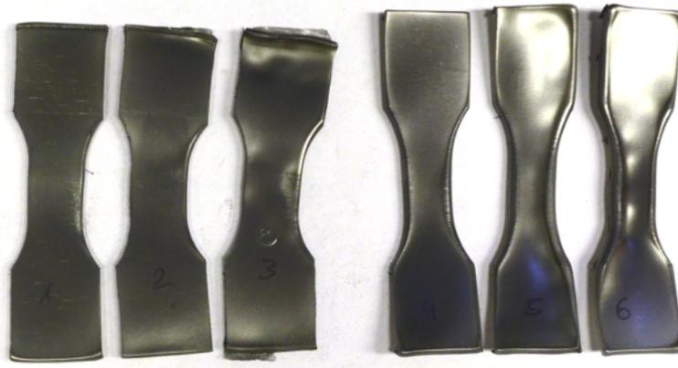
Abb. 5.1: Schwindungsversuche von PP
