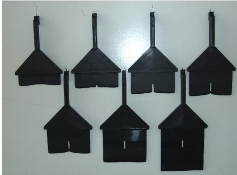
Abb. 3.7: Füllstudie zur Erzeugung einer Fließnaht
