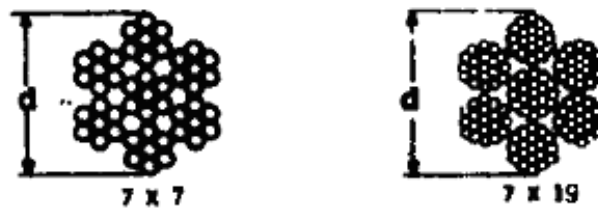
Bild 2.6: Seilkonstruktionen 7 x 7 und 7 x 19 [11]
