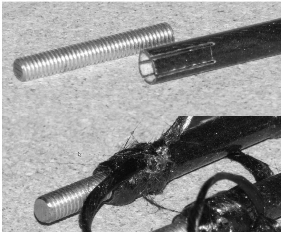
Bild B.8: Krafteinleitungstyp X, vor und nach der Verklebung
