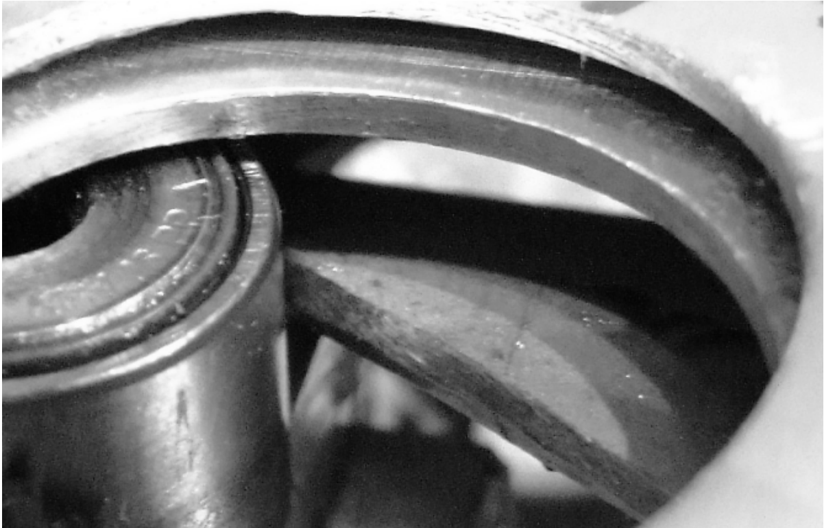
Bild 7.9: Kurvenrolle und Rollenbahn am Ende der Lebensdauer
