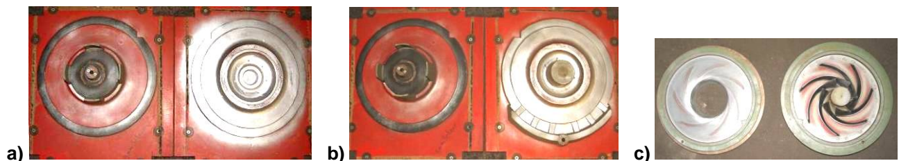
Bild 6.15 a) Modell zu Teil D, b) Modell zu Teil D1 (modifiziert), c) gleicher Kernkasten für beide Teile
