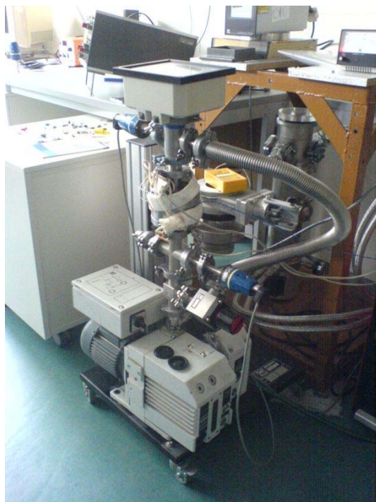
Abbildung 40: Werkzeug Mk. IV im Zusammenbau mit Heizmanschette und Vakuumpumpe (links). Der Werkzeugeinsatz auf der Prüfmaschine, mit der die Proben verdichtet wurden (rechts).
