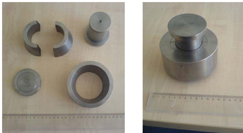
Abbildung 39: Werkzeug Mk. IV zur Herstellung von Druckproben (links zerlegt, rechts zusammengesetzt)
