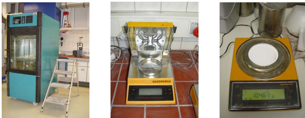
Abbildung 23: Versuchsaufbau (von links): Klimaschrank, Feuchtemessgerät Sartorius MA30 und Sartorius-Waage zur Bestimmung der Feuchteaufnahme mit einem Probenträger
