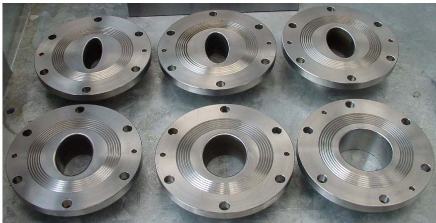
Bild 93: Austauschbare elliptische Matrizen für die werkstofftechnischen Versuche
