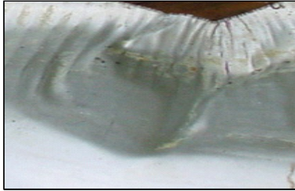
Bild 79: Materialnachschub und Faltenbildung beim HIU-Tiefziehen
