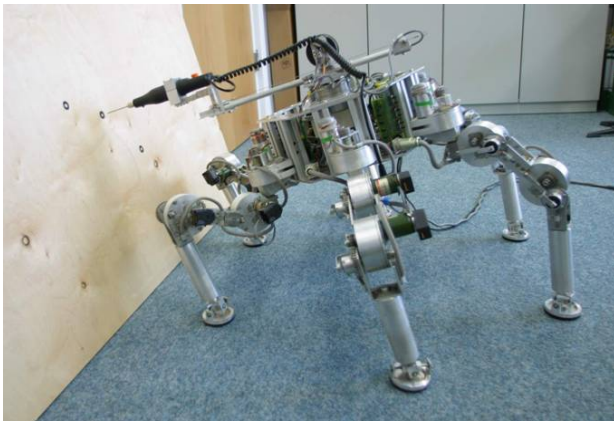
Abb.4.24. Einstellung des Bohrers senkrecht zur Bearbeitungsoberfläche durch die entsprechende Körperorientierung.
