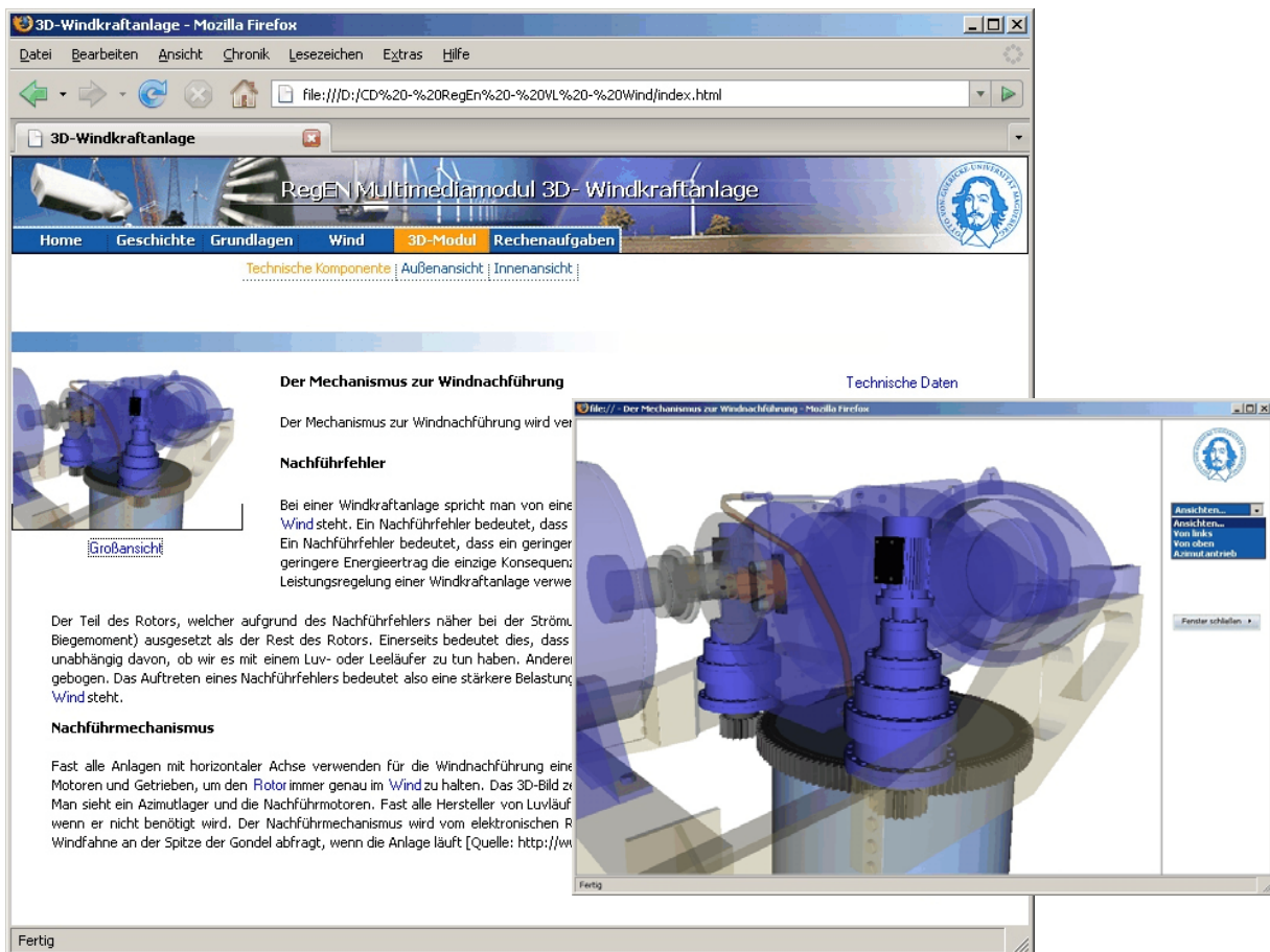
Abb. 35: 3D-Modell und detaillierte Beschreibung des Funktionsprinzips des Azimutlagers einer Windkraftanlage.
