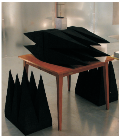
Abbildung 3.15: Kammgenerator »RSG2000« mit vier zusätzlichen Absorberblöcken. Im Falle der Beladung mit zwei Blöcken fehlten die Absorber auf dem Boden.
