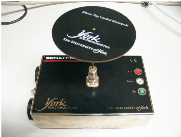
Abbildung 3.10: Der Rauschgenerator »CNEIII« mit 100 mm Monopolantenne.
