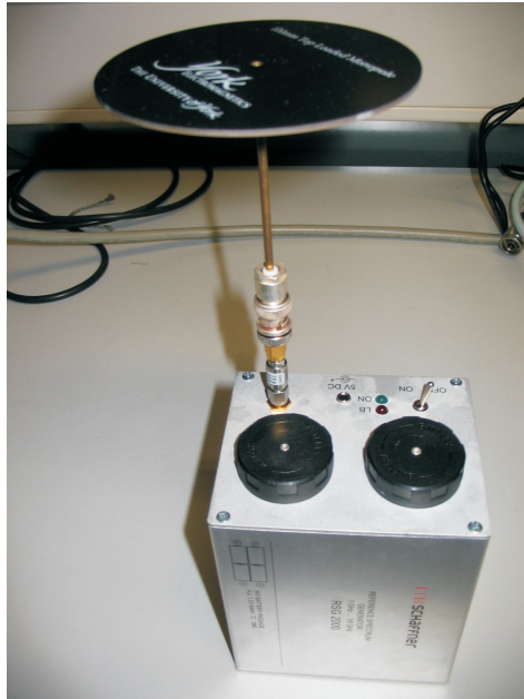
Abbildung 3.11: Kammgenerator »RSG2000« mit Abschwächer und aufgesetzter Monopolantenne.
