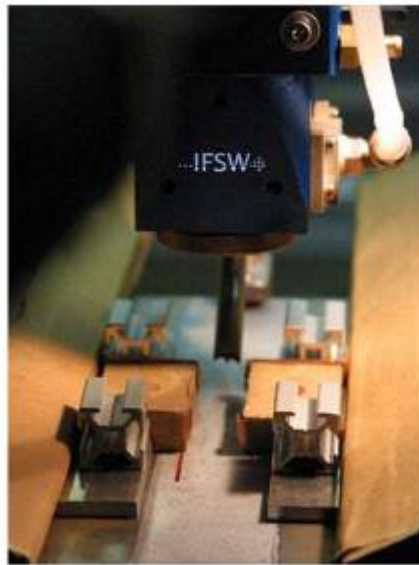
Bild 58: Versuchsaufbau der magnetischen Beeinflussung des Schweißbades [Foto: IFSW]
