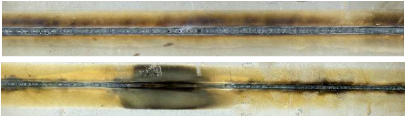
Bild 62: CO 2 -Laserschweißung an ZE-Mg 35/35 beschichteten Dreifachüberlappstößen H220Y. Konventionelle Optik. Spannsystem: streifenförmigen Spannbacken mit relativ geringer Spannkraft. Oben: Oberfläche; unten: Wurzelseite
