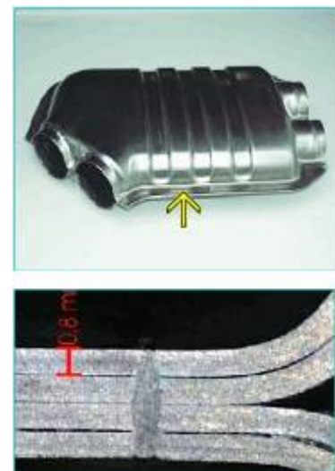
(b) im Abgasanlagebau an unbeschichteten CrNi-Blechen [Quelle: Laserzentrum Schorcht GmbH]
