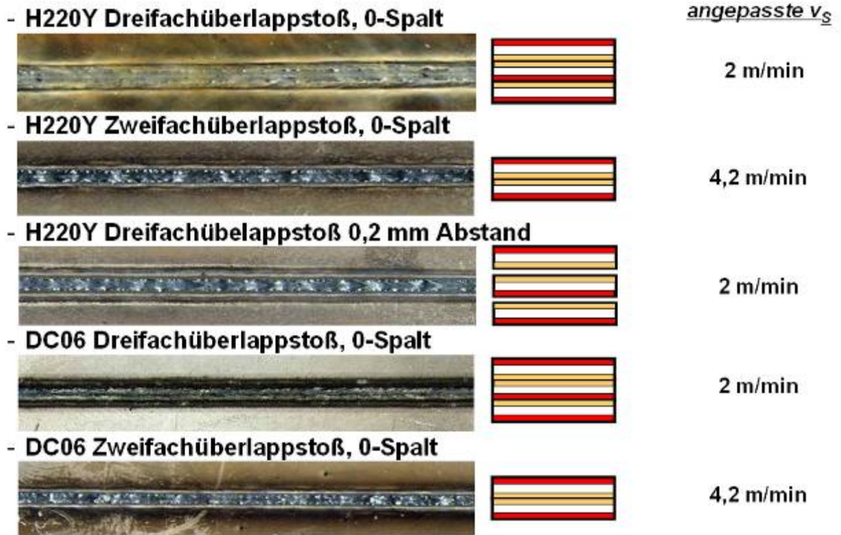
Bild 43: Vergleichsuntersuchungen an den Werkstoffen H220Y und DC06 (Stoßauslegung, Schweißgeschwindigkeit und Nahtoberflächen)
