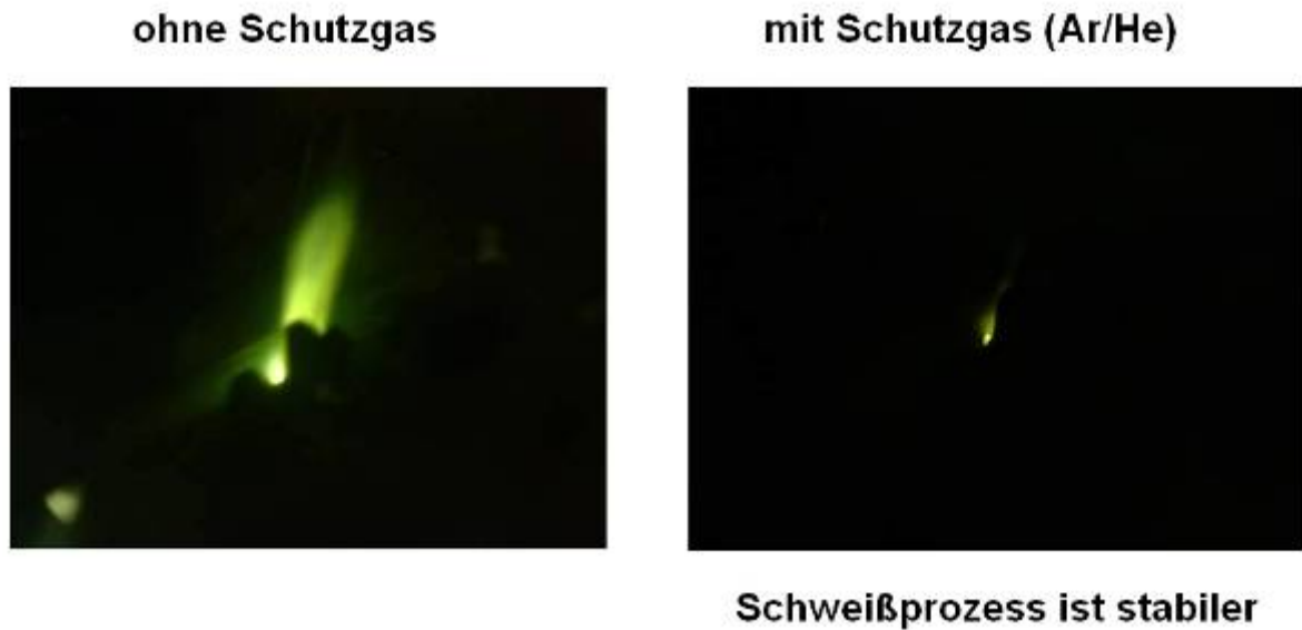
Bild 53: Metalldampfplüchten an der Schweißstelle
