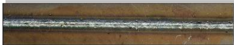
Bild 32: Einfluss des Pulsbetriebes. Werkstoff DC04+ZE 75/75 (Variante 4 nach Bild 22)
