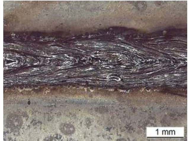
Bild A4-30: Probe M23, Zusatzstrom 300A (-/+), Hufeisenmagnet
