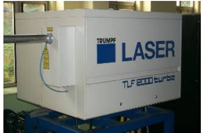
Bild 17: Axial schnellgeströmter CO 2 -Laser TLF12000 turbo der Fa. Trumpf
