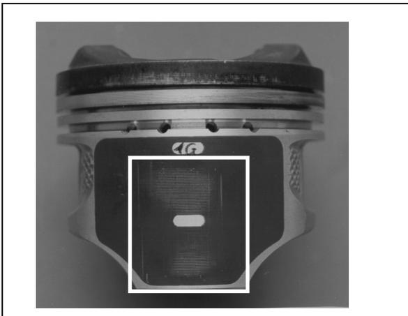
**Bild 6.1.1-3:** Gegendruckseite des Kolbens von Zylinder 1 des Versuchsmotors
