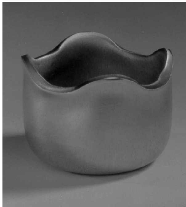
Abbildung 6.6: Zipfelbildung eines tiefgezogenen Napfes aus Aluminium (Engler und Kalz, 2004)
