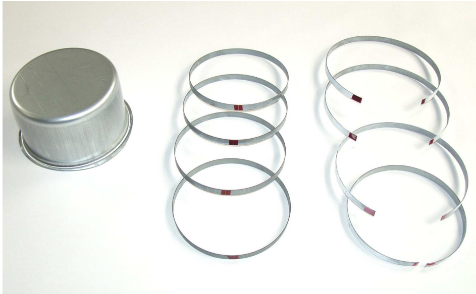
Abbildung 7.11: Rückfederungsversuch: Napf, Ringe, Ringe nach Öffnung
