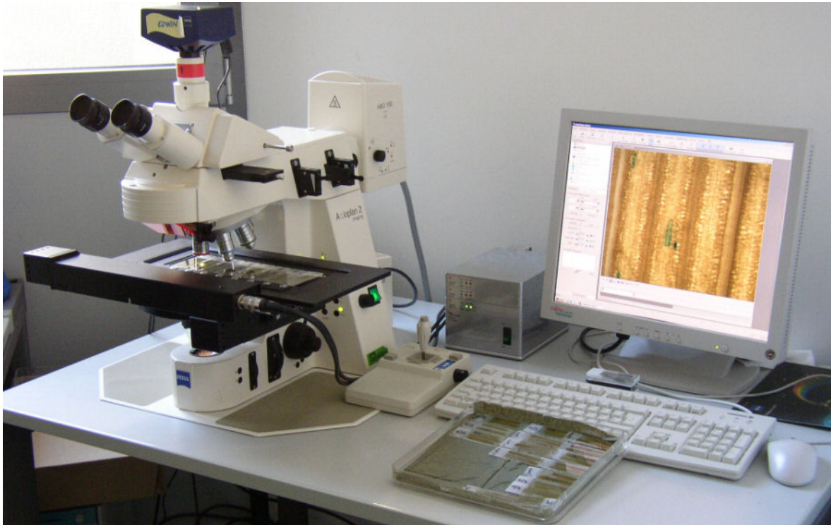
Abbildung 1.3: Computergesteuertes Mikroskop mit X-Y-Tisch und Digitalkamera. Nahezu sämtliche Komponenten lassen sich softwaregesteuert betätigen.
