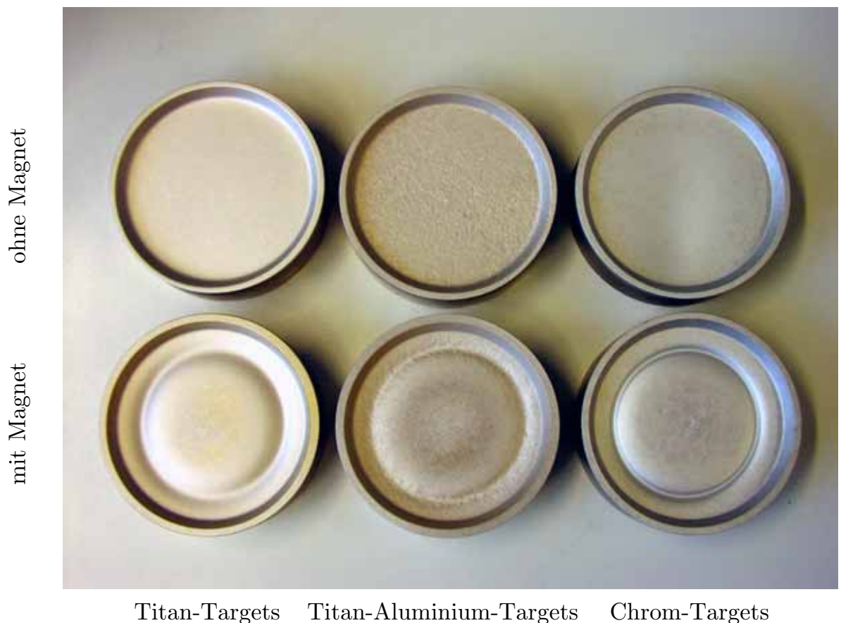
Abb. 5-18 Targetoberflächen nach Beschichtungsversuchen ohne und mit Permanentmagnet
