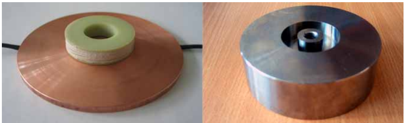
Abb. 6-4 Adapterplatte mit aufgesetzter Spule und passendes gefrästes Ti-Target
