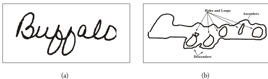
Abbildung 3.9: Die holistische Worterkennung nutzt Merkmale des gesamten Wortes wie Wortlänge, Ober- und Unterlängen und Schleifen [51].
