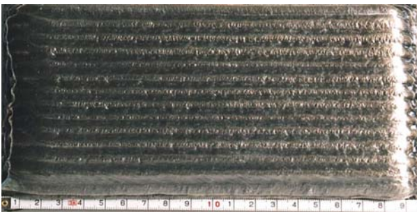
Bild 44: Ergebnisse der Sicht- und Farbeindringprüfungen an ausgewählten reinen MSGp-Schweißgutproben
