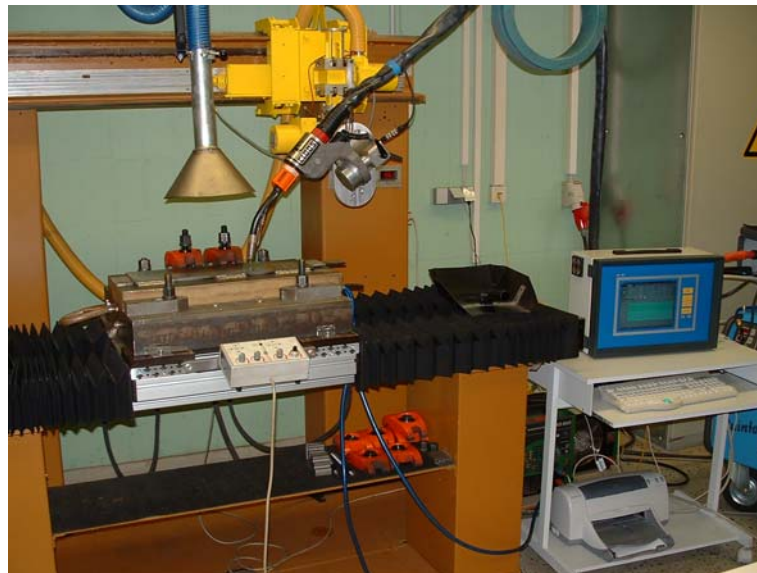
Bild 14: Versuchsanlage für das vollmechanisierte MSG-Impulslichtbogen-Schweißen
