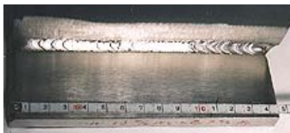
Bild 20: Ergebnisse der Sicht- und Farbeindringprüfung von ausgewählten Doppelkehl-nahtproben
