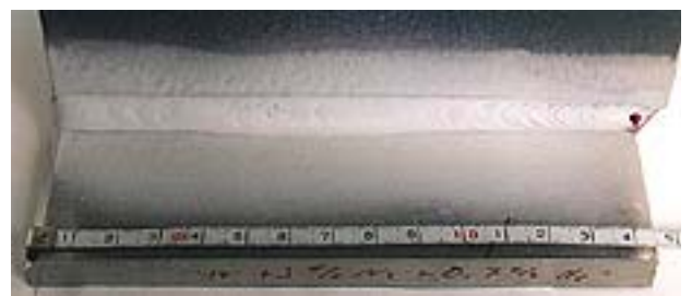
Bild 20: Ergebnisse der Sicht- und Farbeindringprüfung von ausgewählten Doppelkehl-nahtproben
