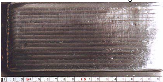
Bild 32: Ergebnisse der Sicht- und Farbeindringprüfungen am Beispiel ausgewählter WIG-Schweißgutproben
