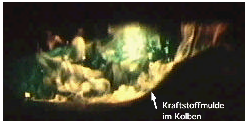
Bild 4-2: Extremes Beispiel eines rußenden Kraftstoffabbrandes in der Kraftstoffmulde. Die hellgelben Flammen sind Diffusionsflammen, die eine rußende Verbrennung anzeigen.
