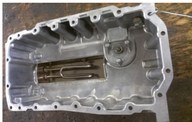
Abbildung 6-27: Öl-Wanne mit 1400W Heizelement
