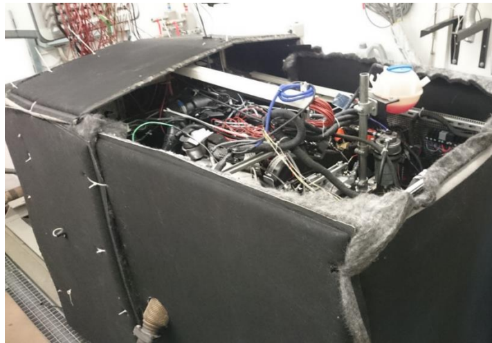
Abbildung 6-34: Versuchsträger mit motorferner Kapselung mit geöffnetem Deckel
