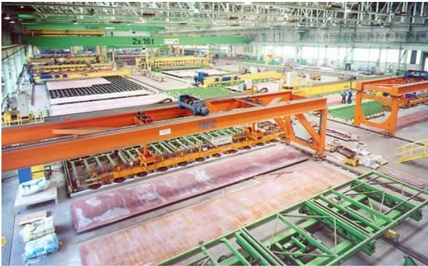
**Bild 11.** Transport der Bleche aus dem Zwischenlager neben der Paneellinie an die Schweißstation
