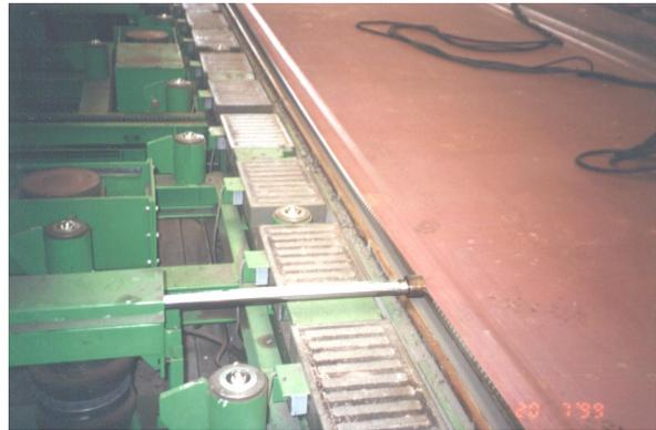
**Bild 12.** Justierung des ersten Bleches auf die Mitte der Badsicherung
