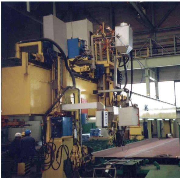
**Bild 9.** UP-Tandem-Anlage
