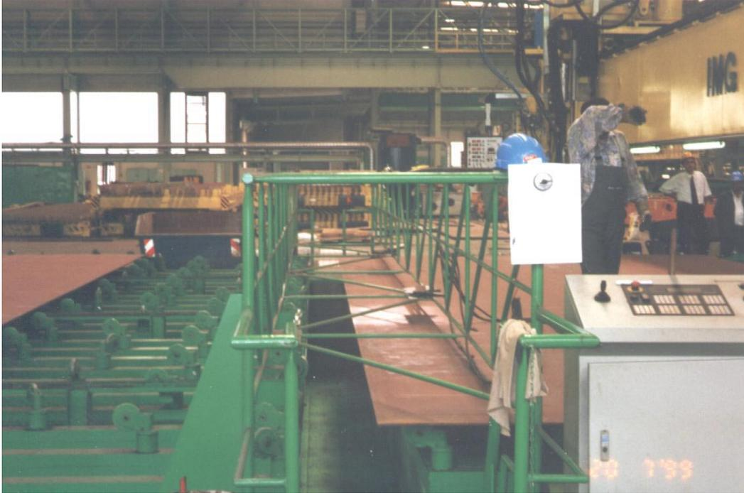
**Bild 15.** Grube für visuelle Kontrolle der Wurzel
