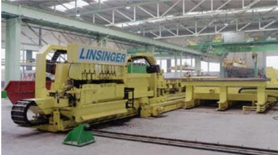
**Bild 8.** CNC- bzw. DNC-gesteuerte Blechkantenfräsmaschine
