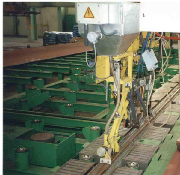
**Bild 10.** Bodenausrüstung, Magnetspannelemente, Schweißbadsicherung
