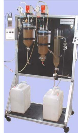
**Abbildung 4-3: Schematische Darstellung und Fotografie der Modellkläranlage II mit vorgeschalteter Denitrifikation (B 1 = Abwasservorratsgefäß, gekühlt, B 2 = anoxisches Denitrifikationsbecken, B 3 = Belebungsbecken, NB = Nachklärbecken, P = Schlauchpumpen)**
