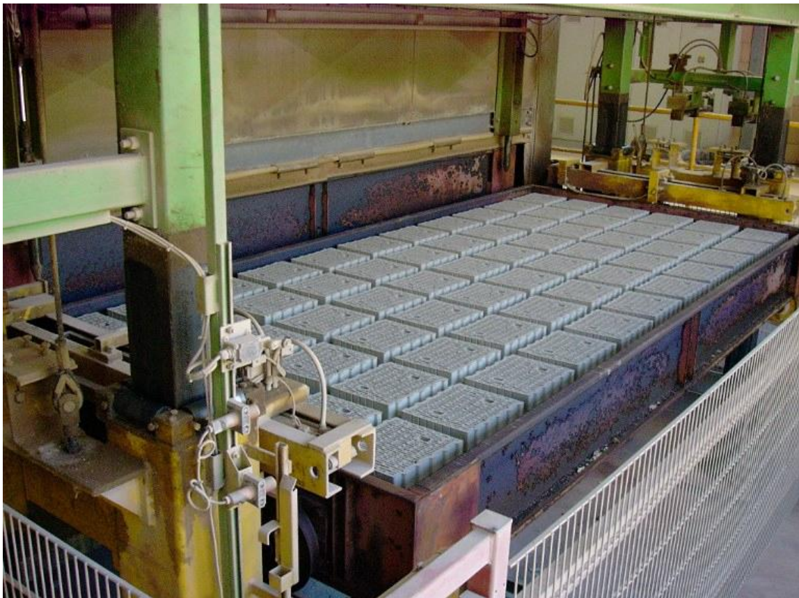
Bild 5: Kassette eines Schnelltrockners für vertikale Durchströmung von Hochlochziegeln
