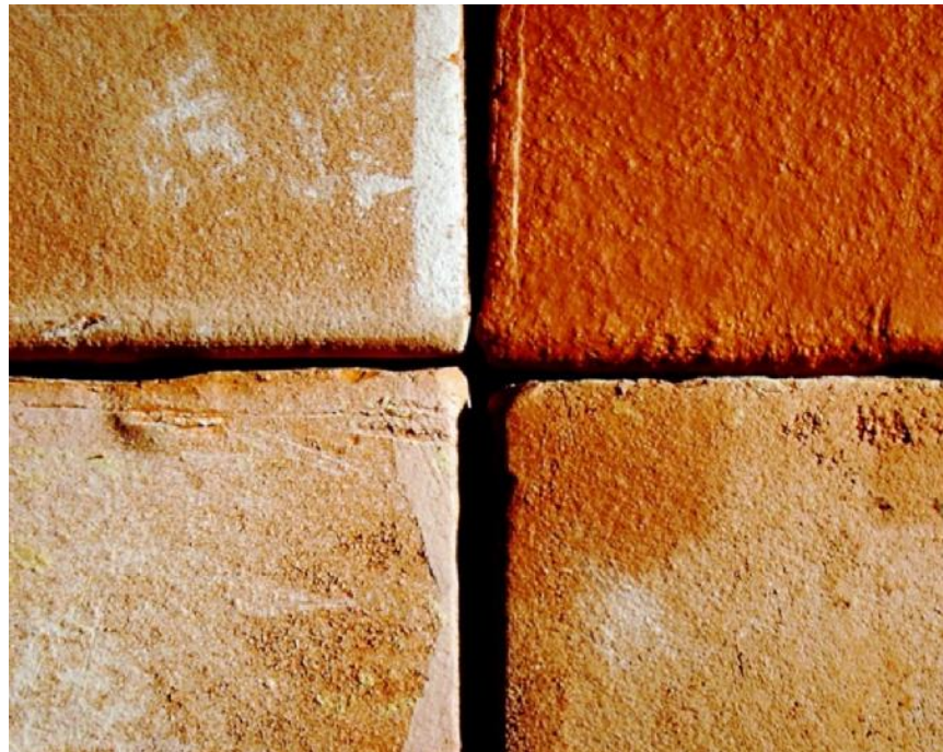
Bild 1: Trockenausblühungen in unterschiedlicher Intensität im Vergleich zur ausblühungsfreien Oberfläche des oberen rechten Probeziegels
