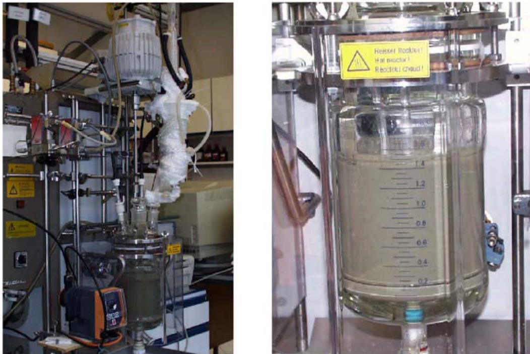
Abb. IV.9: Versuchsstand Reaktionskalorimeter und laufender Versuch
