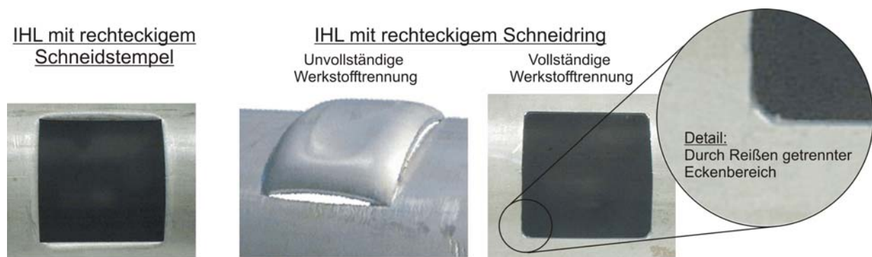
Bild 2-9: Innenhochdrucklochen mit rechteckigen Lochgeometrien (nach /50/)
