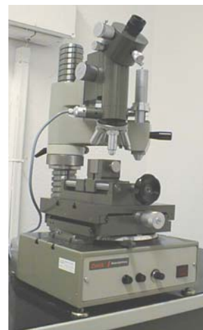
Bild 5-5: 100 kN Wolpert-Universalprüfmaschine (links) und Zwick-Härteprüfmaschine (rechts)
