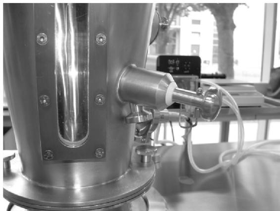
Abbildung 4.3: Probenahmestutzen der Versuchsanlage GPCG 1.1
