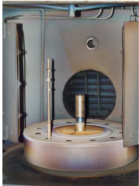
Bild 10: Aufstellung der zu beschichtenden Wendeschneidplatten in der Vakuumkammer der Beschichtungsanlage
