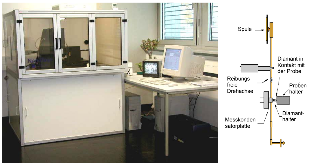
Bild 58: „Nanotest“ - Messgerät zur Erfassung mechanischer Eigenschaften von Beschichtungen und Oberflächenrandzonen; schematische Darstellung des Messaufbaus
