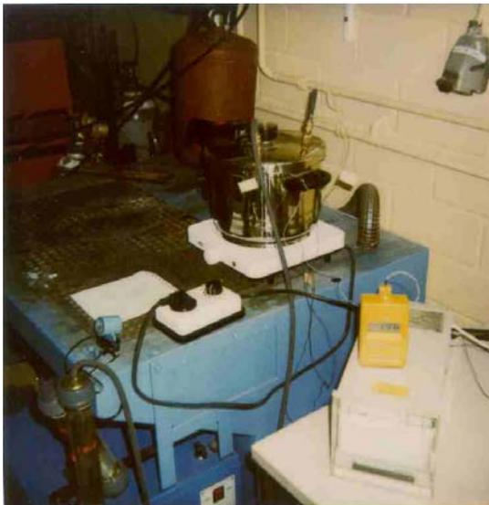
**Bild 47:** Untersuchung des Einflusses eines erhöhten Wasserdurchflusses auf die Wärmeaufnahme im erwärmten Kühlkanal des Brenners Typ 411
