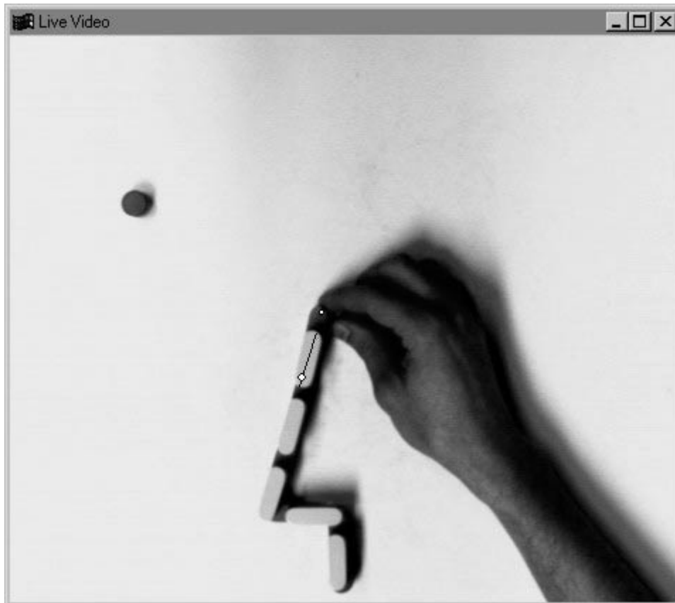
Abbildung 26. Streckensteine (teilweise gebaute Strecke, letzter Stein mit aus der Steinposition errechneter Linie), Streckenendstein und Hand
