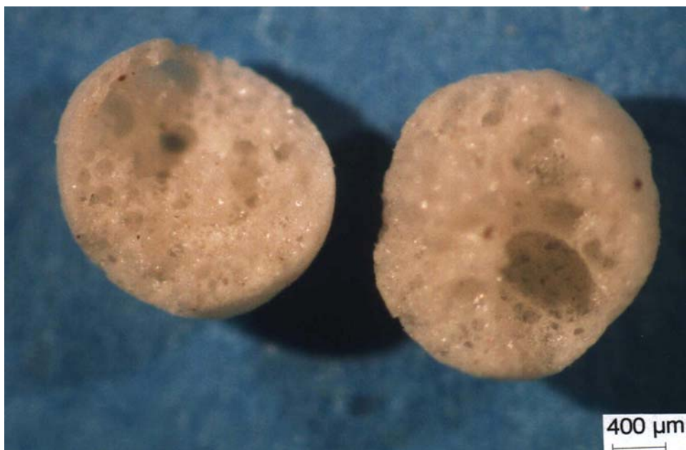
Bild 4.17: Bruchfläche von Poraver-Kugeln; Lichtmikroskopie
