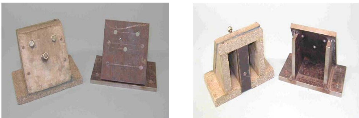
Bild 8.1: Vorrichtung aus HKK-Verbund (links in den Bildern) und aus Stahl (rechts in den Bildern)
