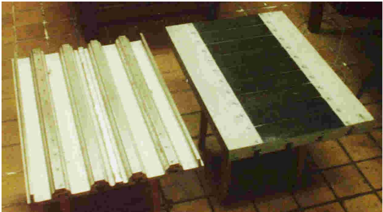
Bild 8.9: Fräsmaschinentisch aus Stahl (links im Bild) und aus HKK-Verbund (rechts im Bild)
