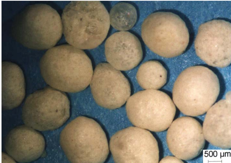
Bild 4.16: Schüttgut Poraver; Lichtmikroskopie
