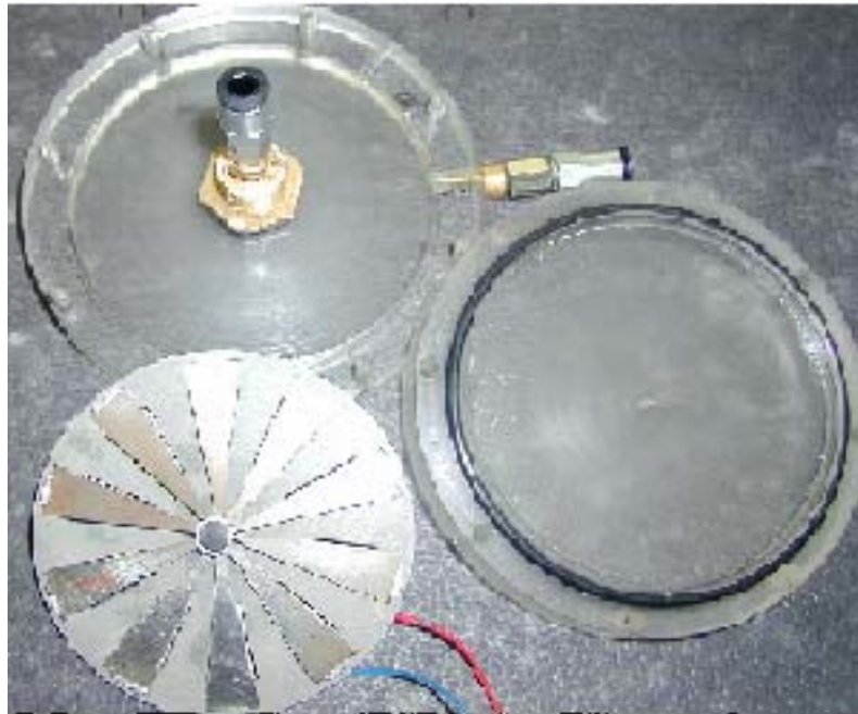
Bild 5.18 Darstellung des piezoangetriebenen 2/2-Wege Sitzventils
