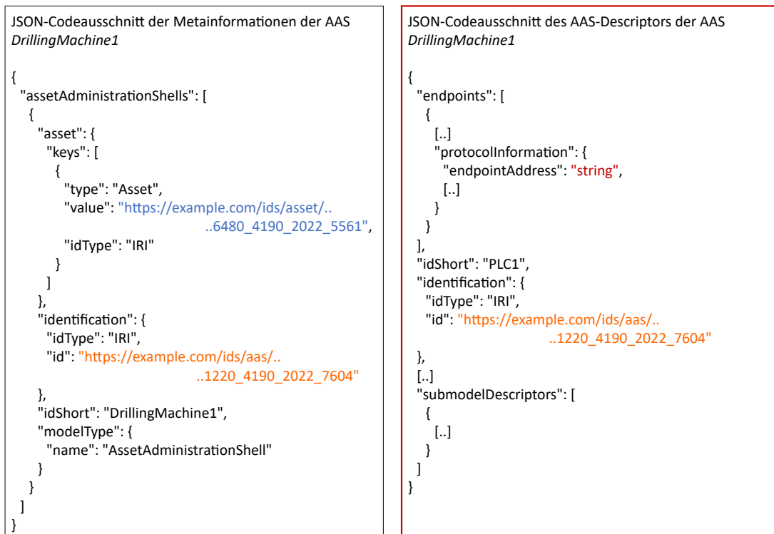
Abbildung 5.10: JSON-Codeausschnitt der Metainformationen von der AAS DrillingMachine1 (links) und deren AAS Descriptor (rechts)
