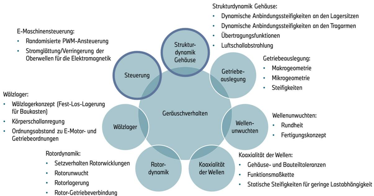
**Abbildung 7:** Einflussfaktoren auf das Geräuschverhalten eines elektrischen Antriebs
