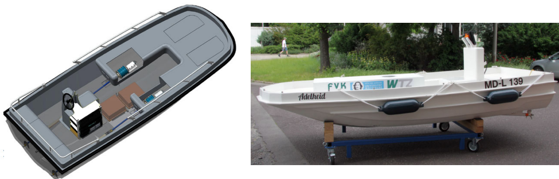
Bild 7: E-Gleiter mit zwei Antriebsmotoren
