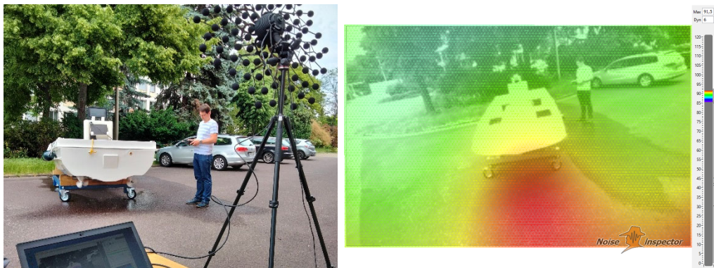
Bild 9: Messung mit akustischer Kamera am E-Gleiter im „Trockendock“
