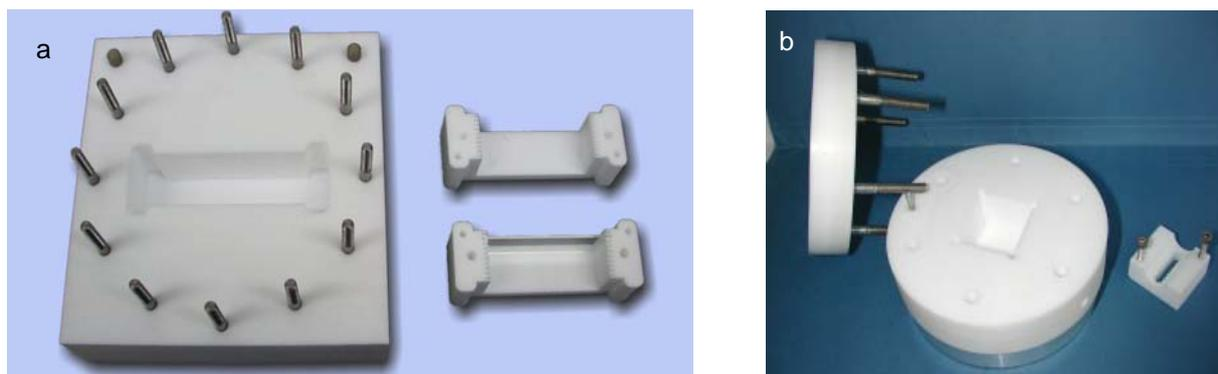
Abb. 22: PTFE-Reaktionskammer für die Self-Assembling
