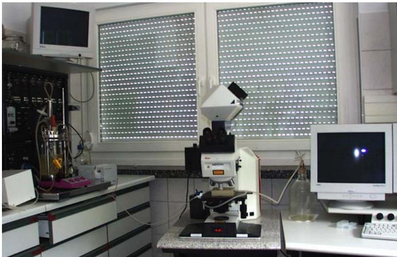
Abb. 26: Bioadhäsionsmessplatz mit Fluoreszenzmikroskop
