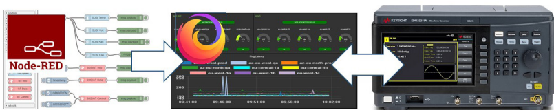
Abb. 4: Funktionsprinzip zur Erstellung von Web-Anwendungen mit Hilfe grafischer Blöcke innerhalb von Node-RED (Mozilla 2022; OpenJS Foundation 2022; dataTec 2022).
