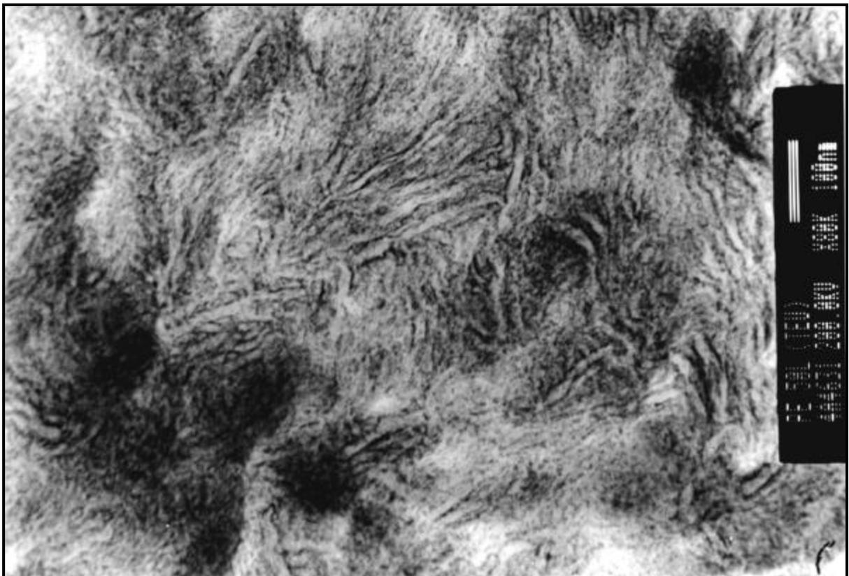
Bild A9: Lamellenstruktur des PE-HD-Werkstoffes D90
