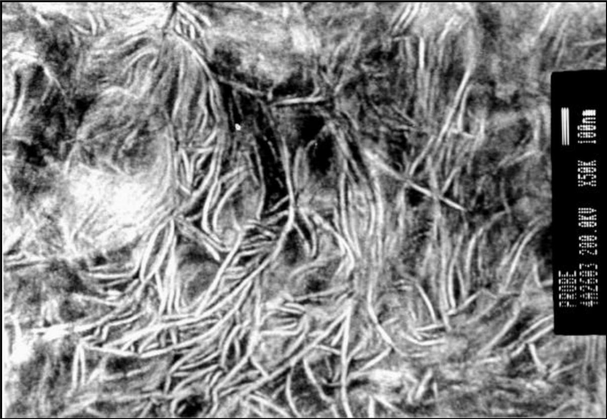
Bild A4: Lamellenstruktur des PE-HD-Werkstoffes M36
