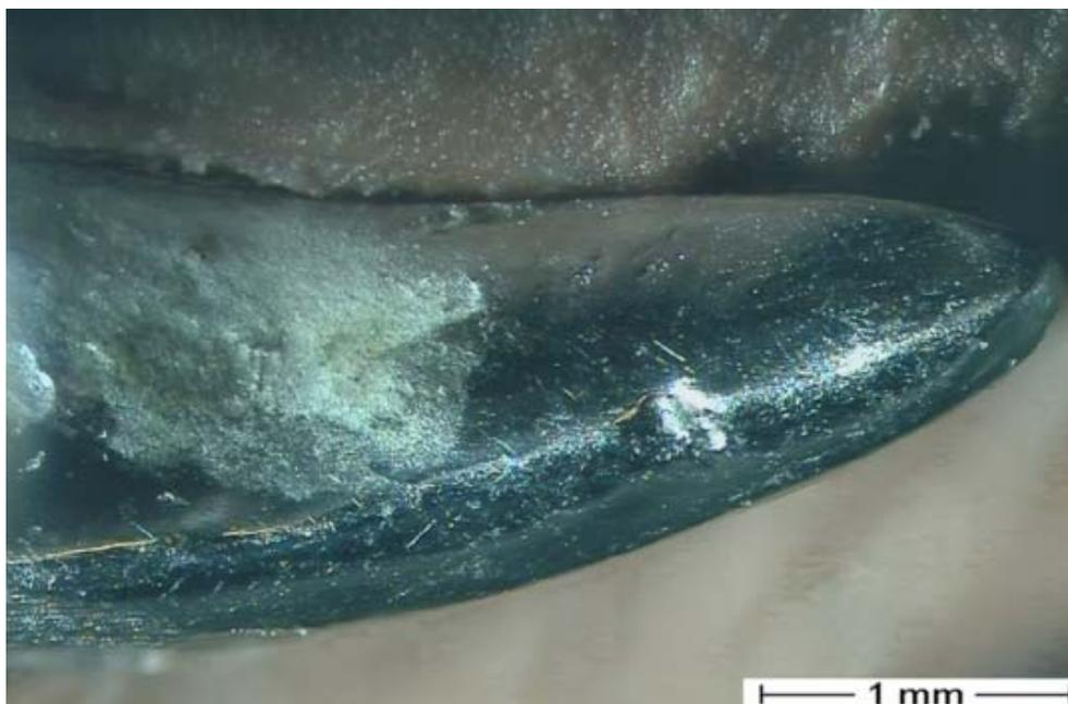
**Abb. 37:** Lichtmikroskopische Aufnahme der Klammerinnenseite von Klammer K II vor den Belastungszyklen auf der Keramikkrone.
