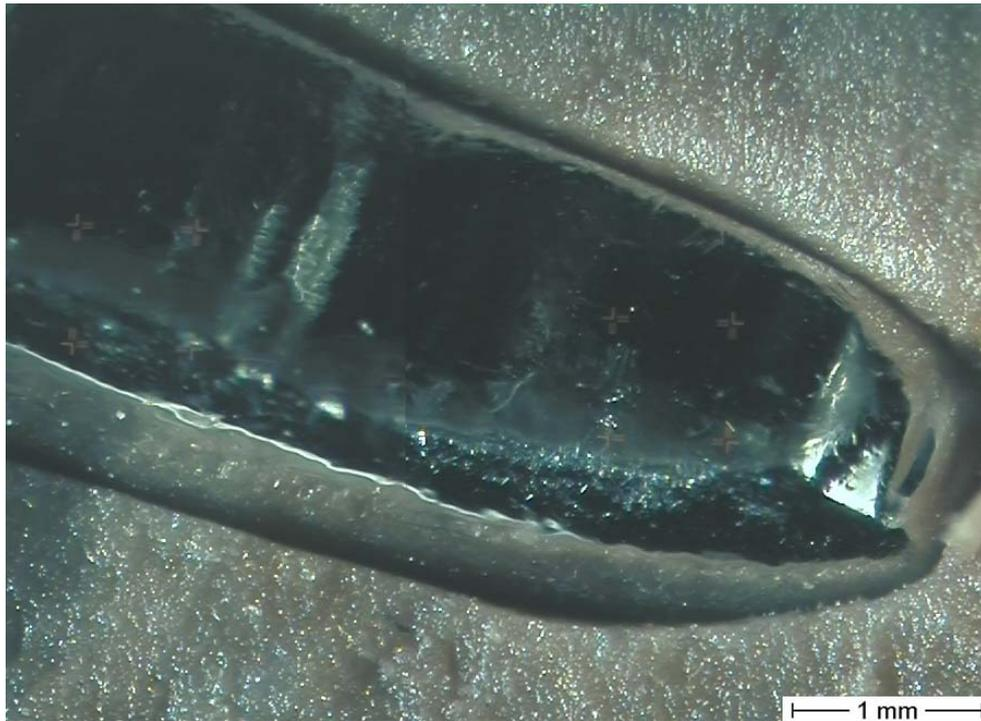
**Abb. 33:** Lichtmikroskopische Aufnahme der Klammerinnenseite von Klammer G II nach 50 Belastungszyklen auf der Goldkrone.
