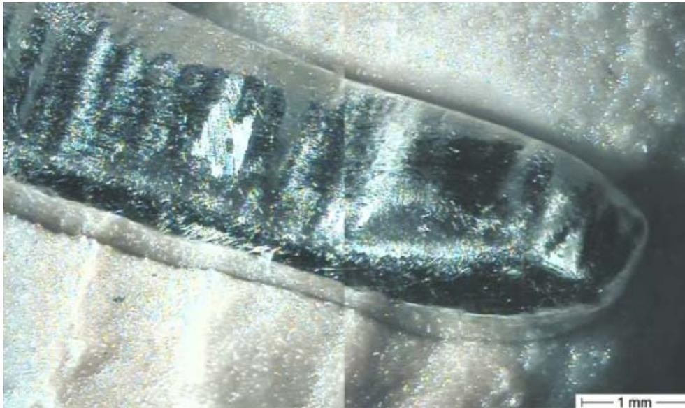
**Abb. 35:** Lichtmikroskopische Aufnahme der Klammerinnenseite von Klammer G II nach 2500 Belastungszyklen auf der Goldkrone.
