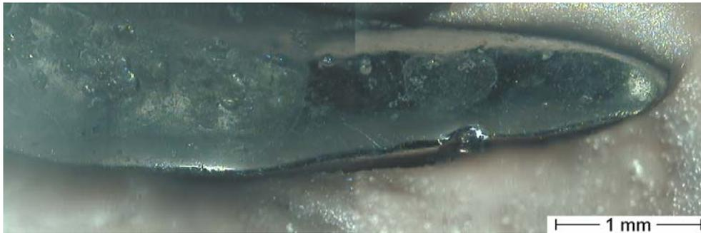
**Abb. 40:** Lichtmikroskopische Aufnahme der Klammerinnenseite von Klammer K II nach 2500 Belastungszyklen auf der Keramikkrone.
