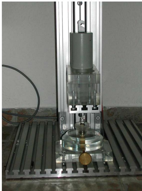
**Abb. 5:** Die Gängelmaschine mit dem darunter befindlichen Speichelbad, in dem eine Krone mit einer noch nicht befestigten Klammer eingelassen wurde. In der Mitte die vertikale Aufbaustange mit dem dazu gehörigen Schlitten und dem 2 kg schweren Gewicht.
