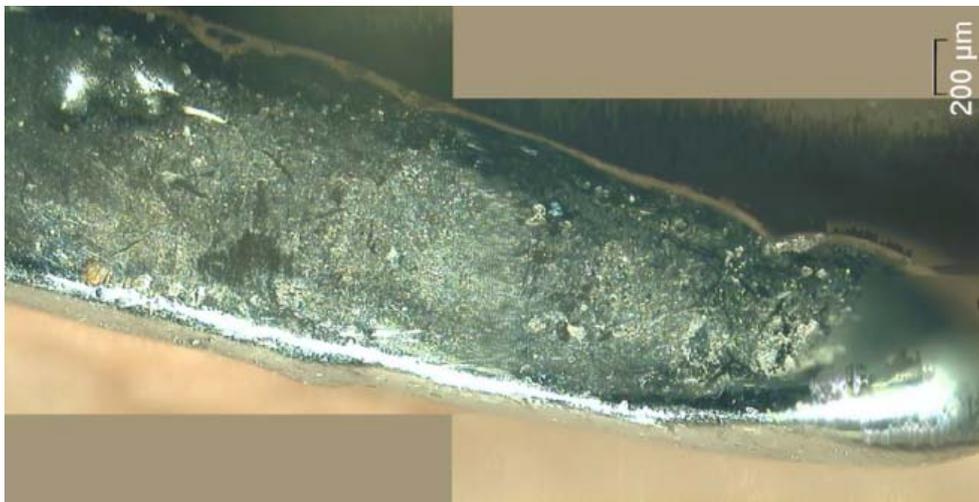
**Abb. 31:** Lichtmikroskopische Aufnahme der Klammerinnenseite von Klammer S IV nach 5000 Belastungszyklen auf natürlichem Zahn.
