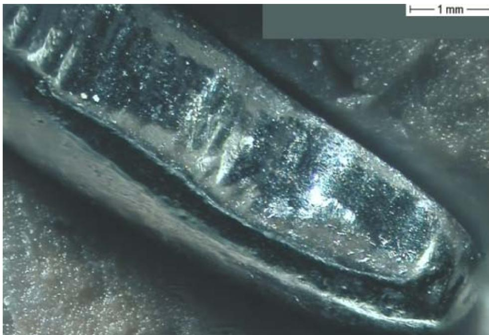
**Abb. 34:** Lichtmikroskopische Aufnahme der Klammerinnenseite von Klammer G II nach 500 Belastungszyklen auf der Goldkrone.
