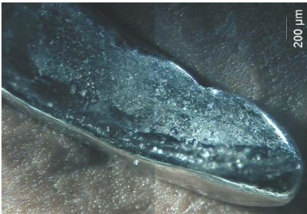
**Abb. 29:** Lichtmikroskopische Aufnahme der Klammerinnenseite von Klammer S IV nach 500 Belastungszyklen auf natürlichem Zahn.
