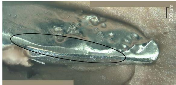
**Abb. 42 und 43:** Die Klammer K I im Ausgangszustand und nach 5000 Belastungszyklen. Die Umrandung in Abb. 43 verdeutlicht den Substanzabtrag der Klammerkante.
