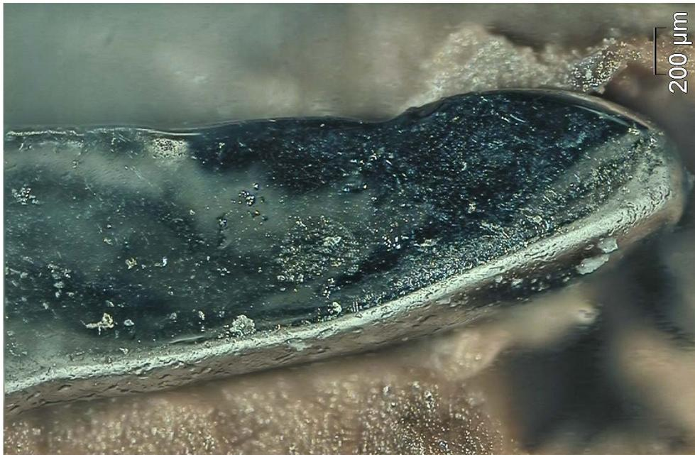
**Abb. 30:** Lichtmikroskopische Aufnahme der Klammerinnenseite von Klammer S IV nach 2500 Belastungszyklen auf natürlichem Zahn.
