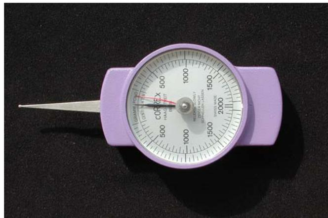
**Abb. 7:** Das Federkraftmessgerät der Firma Correx (Haag-Streit AG, Liebefeld-Bern), Skalenwerte in cN.
