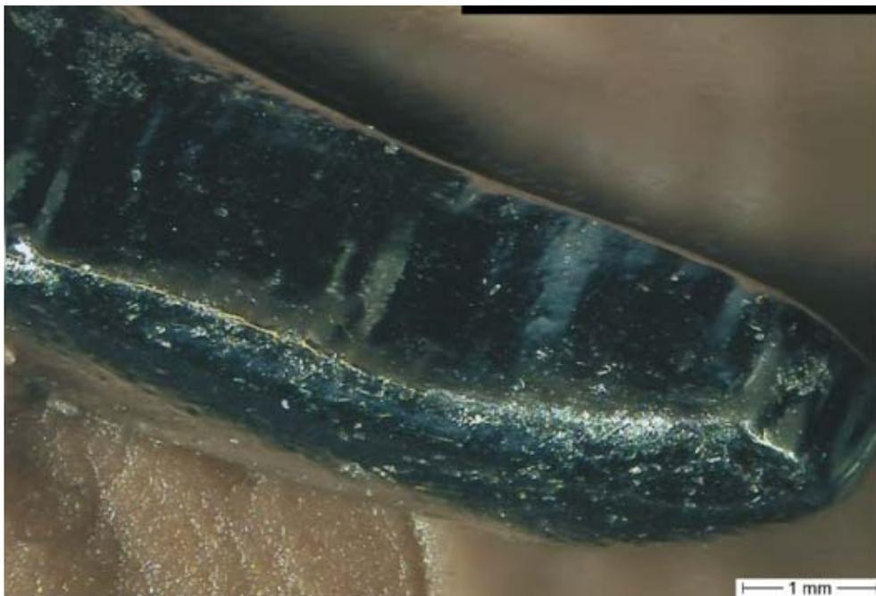
**Abb. 32:** Lichtmikroskopische Aufnahme der Klammerinnenseite von Klammer G II vor den Belastungszyklen auf der Goldkrone.
