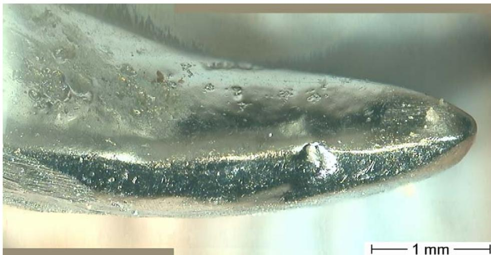
**Abb. 41:** Lichtmikroskopische Aufnahme der Klammerinnenseite von Klammer K II nach 5000 Belastungszyklen auf der Keramikkrone.
