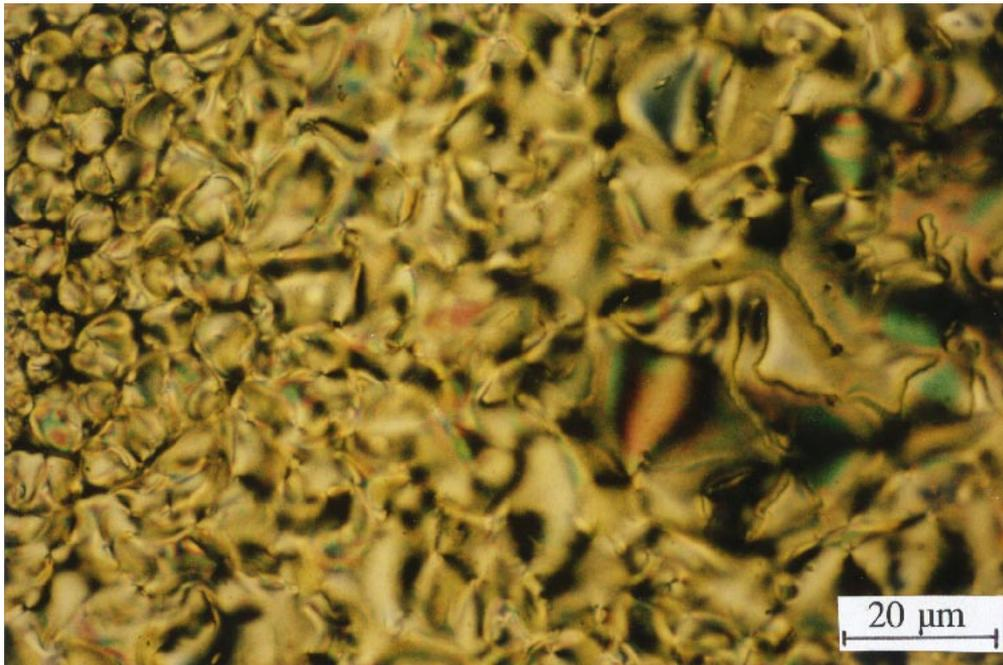
**Abbildung 6:** Polarisationsmikroskopische Aufnahme von (4-(2-hydroxy-3-(4-propoxyphenylene)-carbonyloxy-4-phenyleneoxy)-propoxyphenyl)-4'-(2-hydroxy-3-(4-propoxyphenylene)carbonyloxy-4-phenyleneoxy)propoxyphenylbenzoat während des Abkühlens aus der Schmelze bei 132°C [364]
