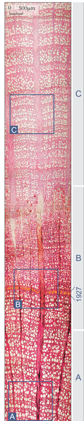
Abb. 6.24: Dünnschnitt des schnell freigelegten Querschnittes 1DD0503e mit markierten Sektionen A, B und C (rechts). Ausschnitte aus den jeweiligen Sektionen siehe oben. Das Jahr 1927 markiert die Grenze zwischen einer typischen Größenreduzierung der Gefäßflächen infolge einer schnellen Freilegung.
