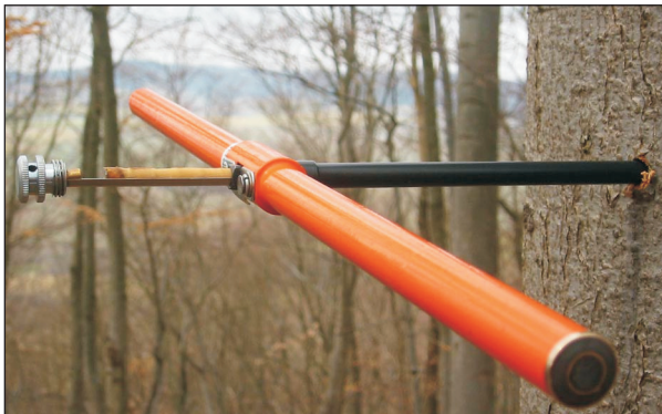
Abb. 5.2: Zuwachsbohrer zur Probenahme am Stamm einer Fagus sylvatica L.
