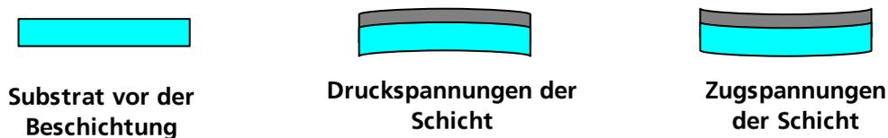
**Abb. 3-11: Arten der Schichtspannung: Zug und Druck**
