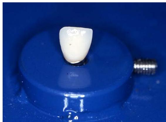
Abb. 24: zementierte Metallkeramikkkrone auf dem Co-Cr-Stumpf in der Haltevorrichtung
