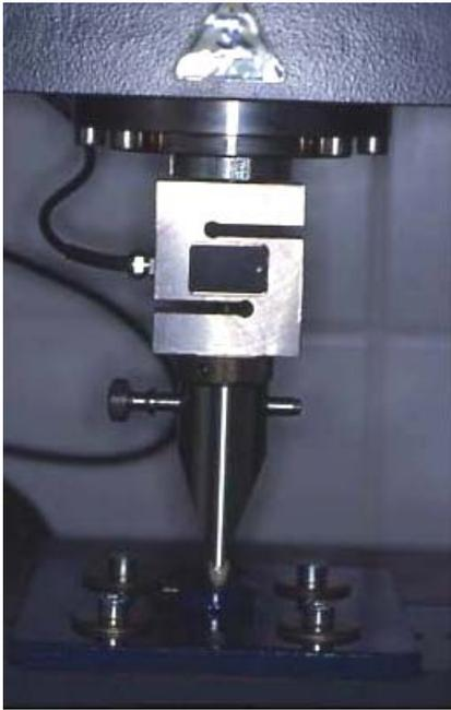
Abb. 27: Versuchsaufbau der Festigkeitsprüfung in der Zwick Z 005
