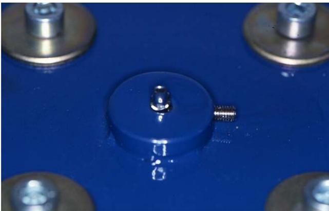
Abb. 25: Haltevorrichtung für den Co-Cr-Stumpf und Fixation in der Universalprüfmaschine
