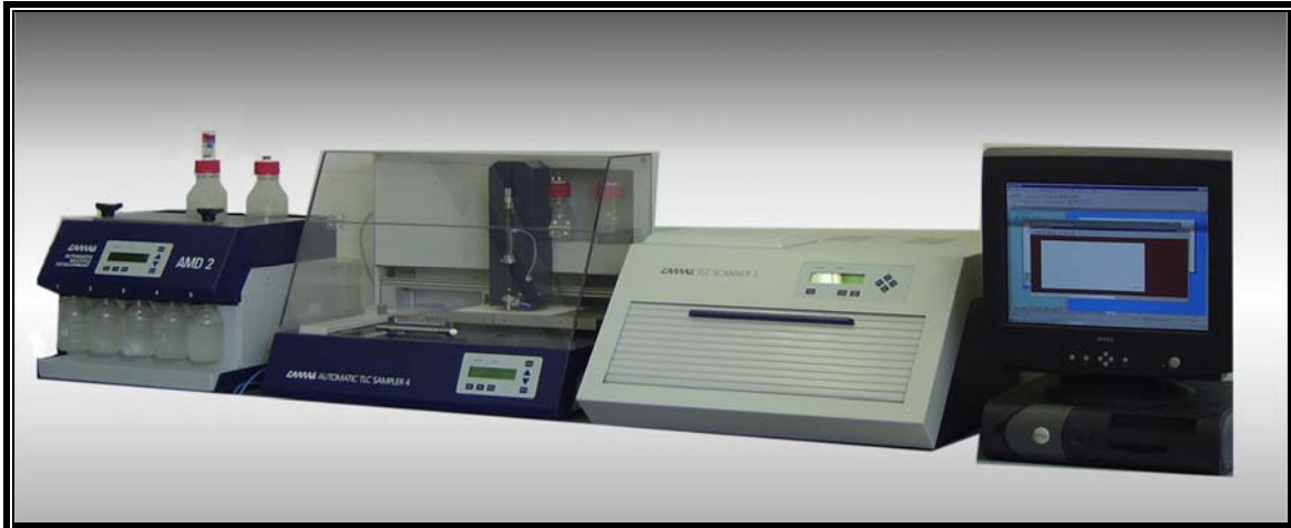
Abbildung 8: Die HPTLC-Einheit; von links nach rechts: AMD 2, TLC-Sampler 4, TLC-Scanner 3, alle computergesteuert
