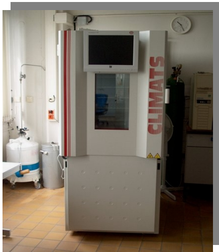
Abbildung 52 Klimatest Anlage - Climats/Sapratin EXCAL 221-H
