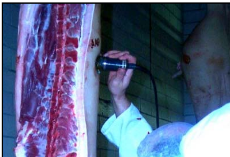
Abbildung A 3: Ultraschallmessung am hängenden Schlachtkörper – Detail -
