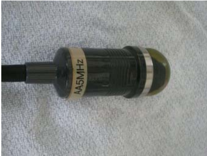
Abbildung A 1: Ultraschallwandler Wobbler AA5A
