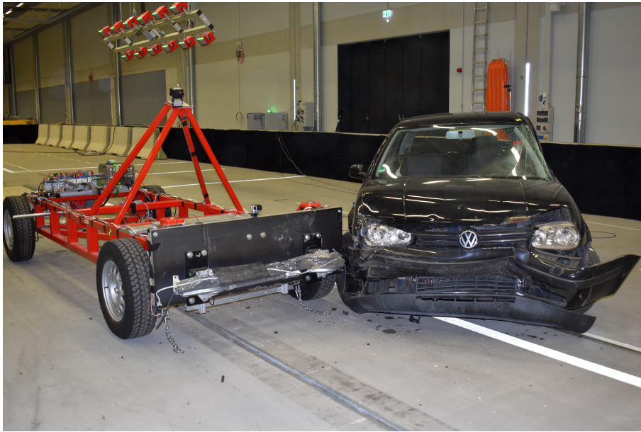
Abbildung A.12: Barriere und Golf nach der Kollision. Die Barriere hat das Fahrzeug um nahezu 180° gedreht, anstatt es wie für Frontalunfälle üblich nach hinten zu verschieben.
