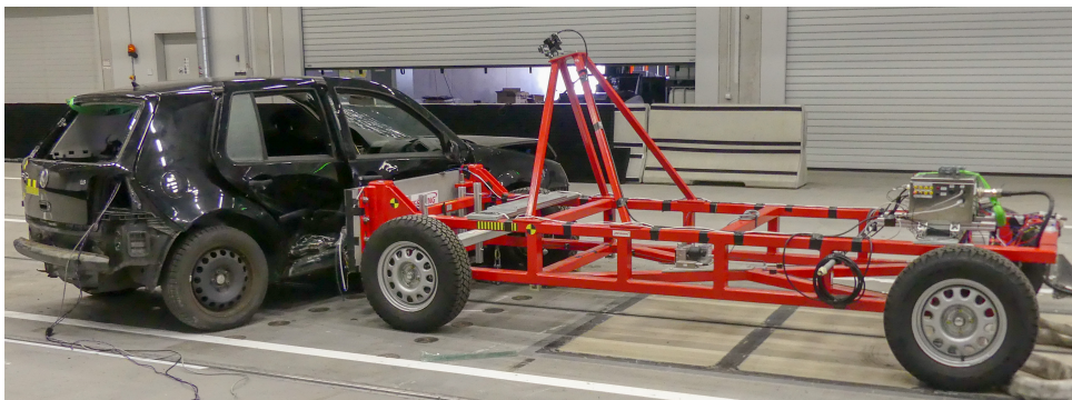
Abbildung A.16: Barriere und Golf nach dem Unfall. Bei Vergleich mit dem Boden aus der vorherigen Abbildung ist zu erkennen, dass die Barriere das Fahrzeug ungefähr 4 m verschoben hat.
