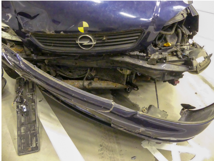
Abbildung A.22: Nahaufnahme der Front des Opel Astras. Während auf der linken, überdeckten Seite das Crashmanagement wesentlich eingedrückt ist, zeigt sich die rechte, weniger getroffene Struktur geringer beschädigt.
