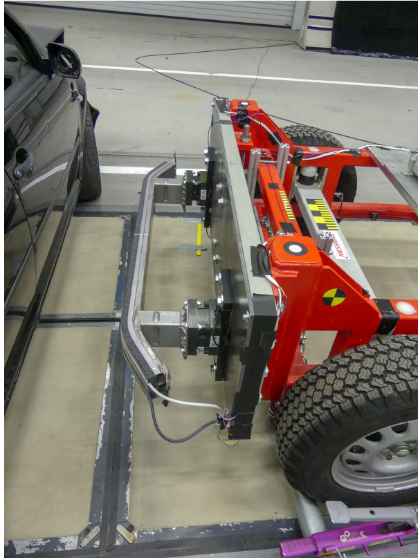
Abbildung A.15: Auf die Mitte der Beifahrertür ausgerichtete Barriere vor der Seitenkollision.
