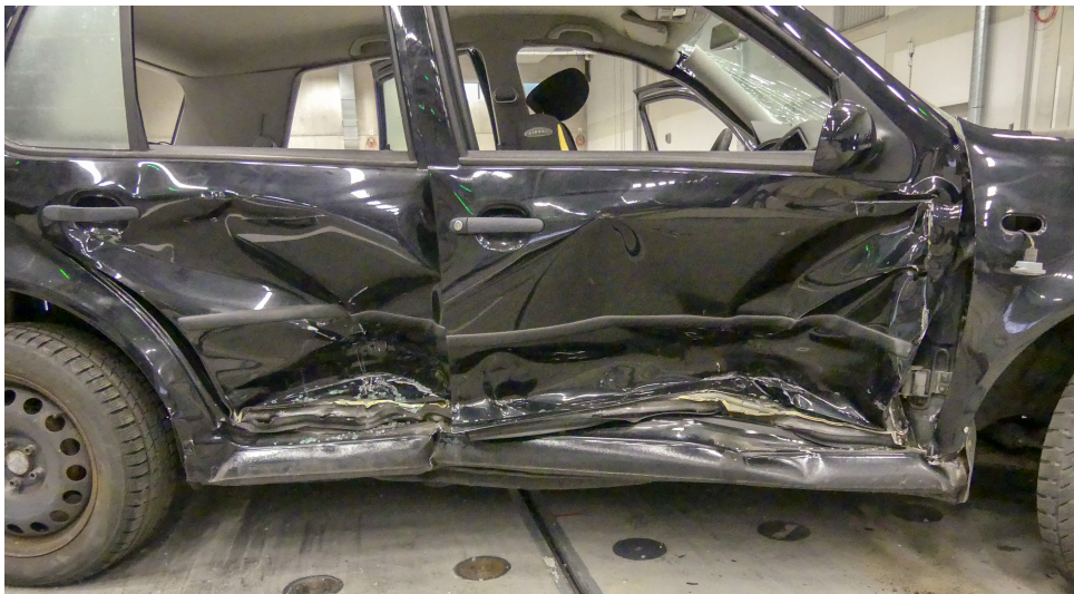
Abbildung A.19: Deformation der Türen des VW Golfs. Auch hier zeigen sich Unterschiede bei der Eindringtiefe in der Mitte der Türen gegenüber der harten B-Säule.
