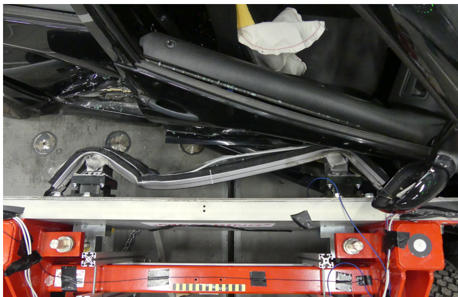
Abbildung A.18: Vogelperspektive zwischen den Objekten. Gut zu erkennen ist die linksseitig stärkere Verformung des Querträgers an der Stelle, welche die steife B-Säule getroffen hat.
