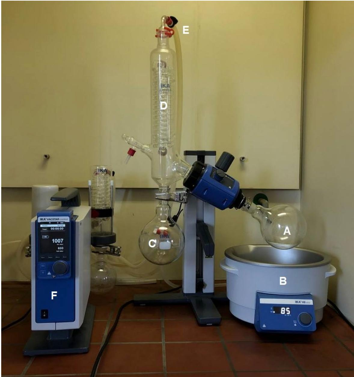
Abbildung 5: Rotationsverdampfer mit Vakuumpumpe
