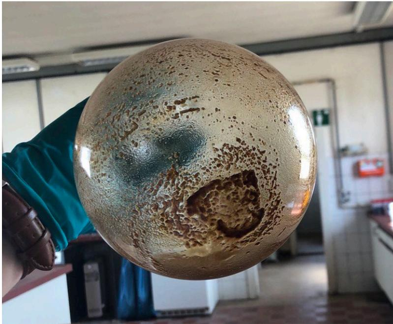
Abbildung 16: Verdampferkolben mit Ablagerungen des Konzentrats, Pr. 2-2
