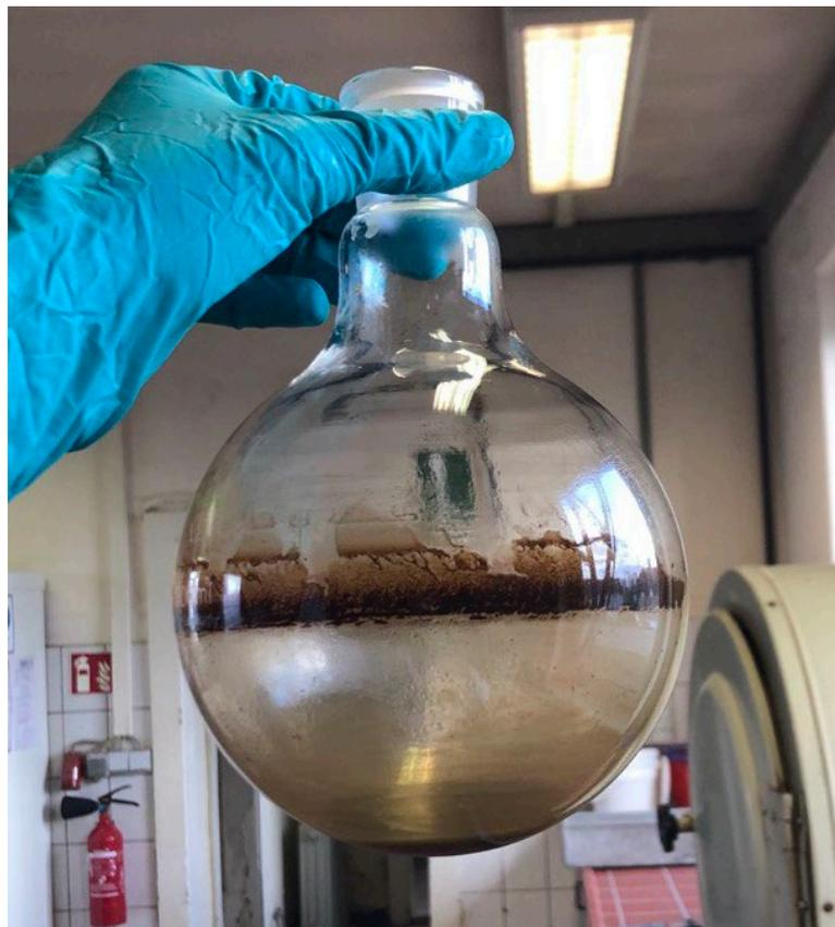
Abbildung 17: Verdampferkolben mit Ablagerungen und Konzentrat der Probe 9-V1
