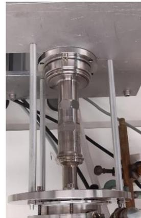
Abbildung 6: Fotografien des genutzten Ultraschallsteuergerätes (Fa. Hielscher, links) und der eingesetzten Sonotrodenspitze (Durchmesser 22 mm).
