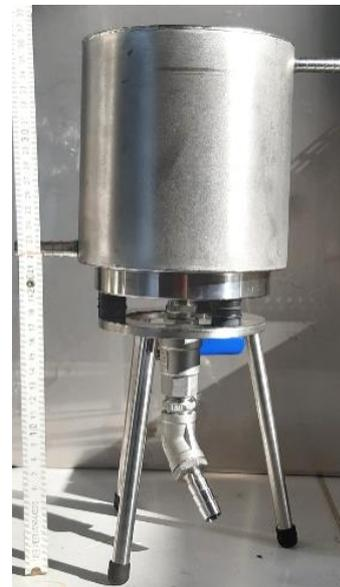
Abbildung 7: Fotografien von Glas- (links: V: 250 ml und 600 ml) sowie Edelstahl- (rechts) Doppelmantelgefäßen, genutzt während der Maßstabsvergrößerungs-Versuche für Up-Scaling Testungen mit der Variation des Reaktionsvolumens und der eingesetzten CDC-Masse (Füllgrad des Reaktors wurde jeweils bei ca. 50% vom Gesamtvolumen gehalten; d.h. real genutztes Reaktionsvolumen betrug entsprechend: 125 ml, 300 ml bzw. 500 ml).
