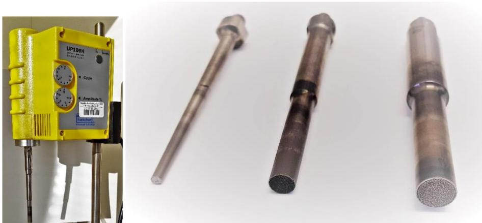
Abbildung 1: Fotografien des genutzten Ultraschallprozessors (Fa. Hilscher; links) und der eingesetzten Sonotroden (Durchmesser: 3 mm, 7 mm, 10 mm).
