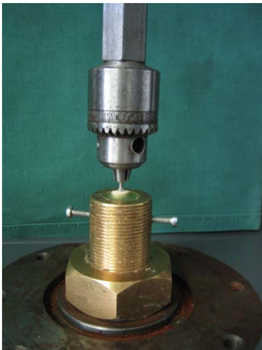
Abb. 4: Eingespannte Probe in der Zugprüfmaschine
