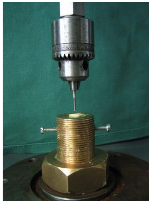
Abb. 5: Vollständiger Abriss des Stiftes aus dem Wurzelkanal
