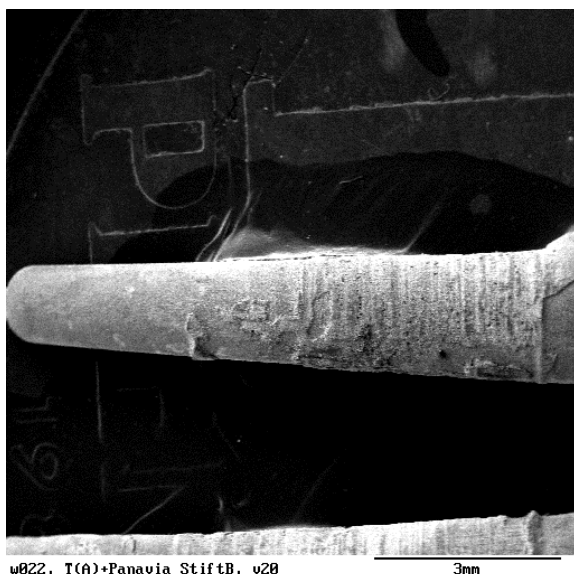
Abb. 33: Titanstifte mit Zementbedeckten und zementfreien Arealen (V. 20)
