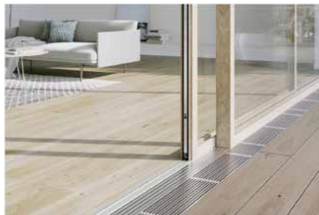
Barrierefreie Schiebetür; 5-mm-Laufschiene und niveaugleiche Trittschwelle ohne Schräge für Barrierefreiheit nach DIN 18040-2 Hersteller: Siegenia
