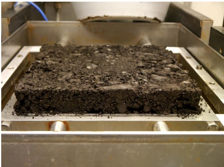
Abbildung 23: Struktur der Probe nach Einbau und manueller Verdichtung. Der obere Scherrahmen wurde unmittelbar nach dem Einbau wieder entfernt (Testeinbau)
