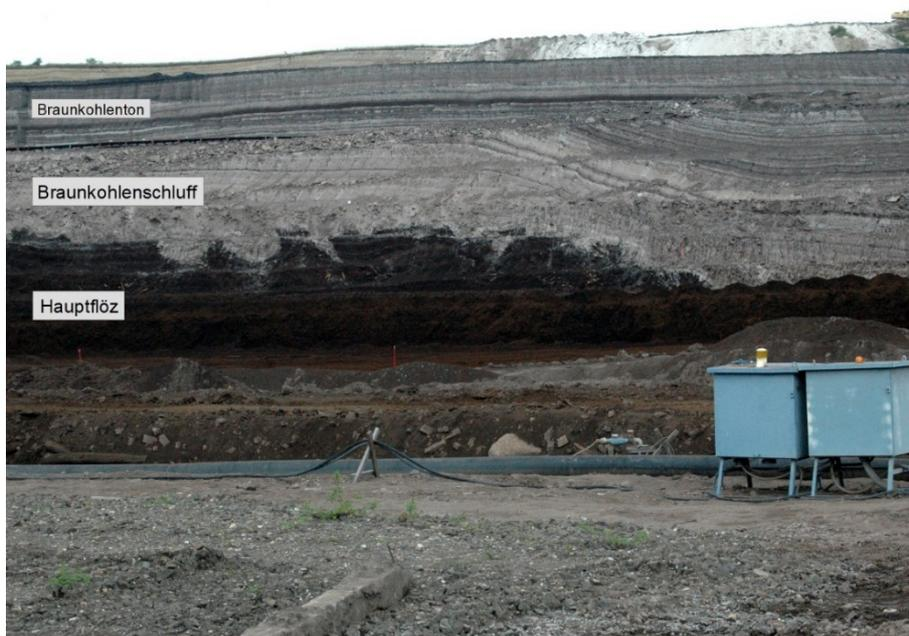
Abbildung 15: Braunkohlenton und Braunkohlenschluff im Abbaufeld Kupferhammer, 4. bis 5. Abraumschnitt
