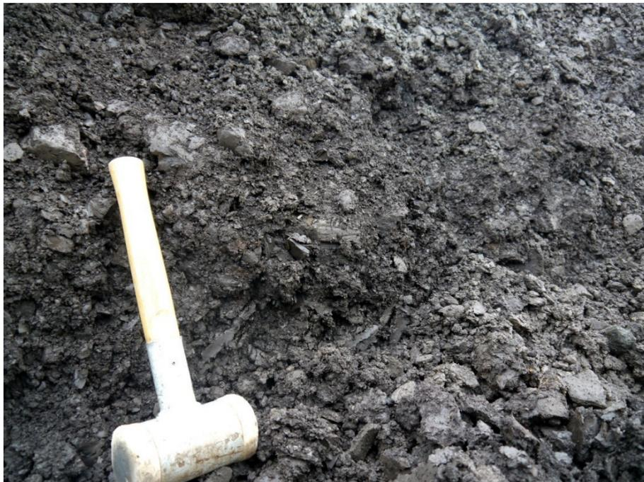
Abbildung 17: Pseudokorngefüge der Kippe im Entnahmeschurf der Probe K1
