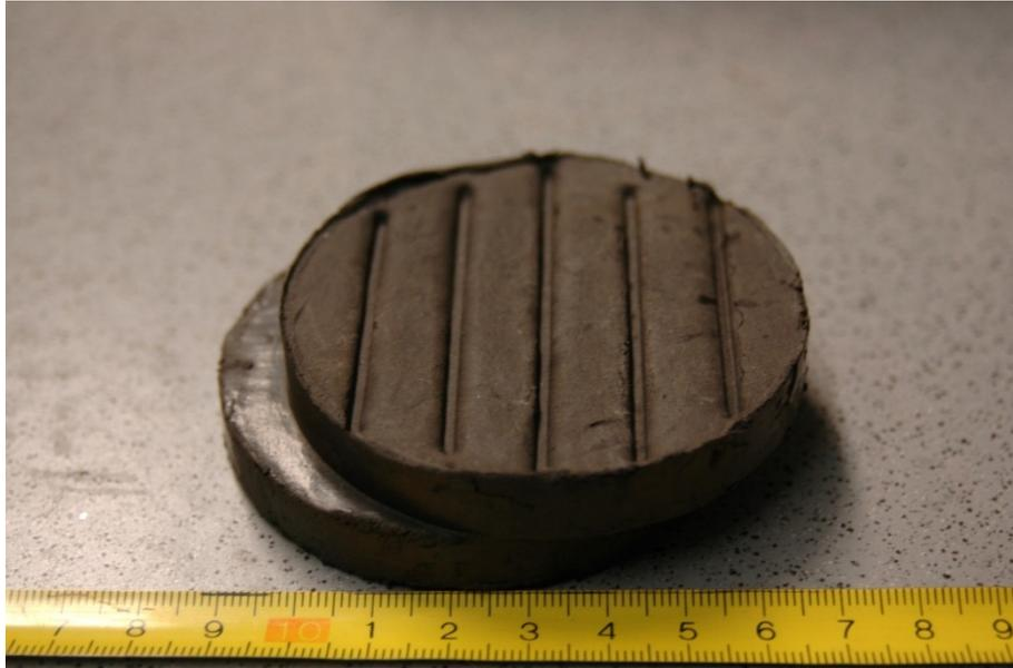
Abbildung 26: *homogene, schwach glänzende Scherfläche beim Rupelton*
