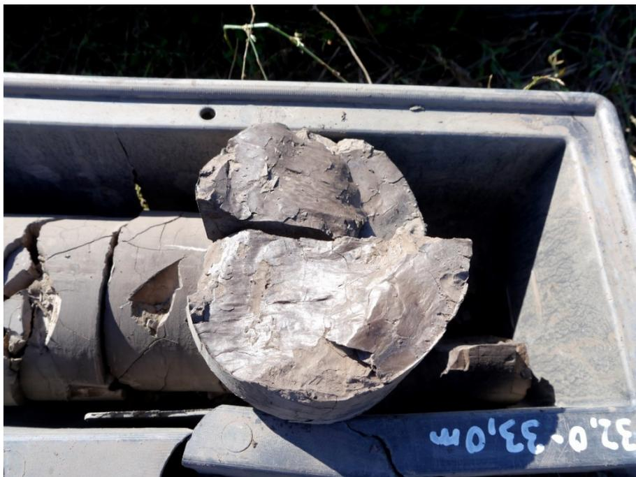
Abbildung 16: Spiegelharnisch im Braunkohlenton, Bohrung B1962/17
