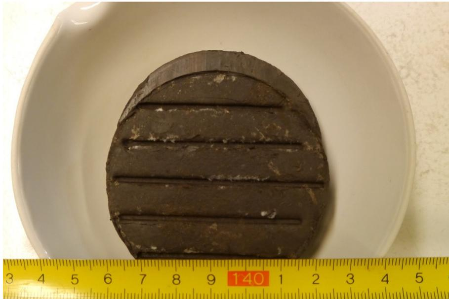
Abbildung 32: homogene, schwach glänzende und schwach gestriemte Scherfläche beim Braunkohlenschluff (oberer Bildbereich, Probe BkU2)
