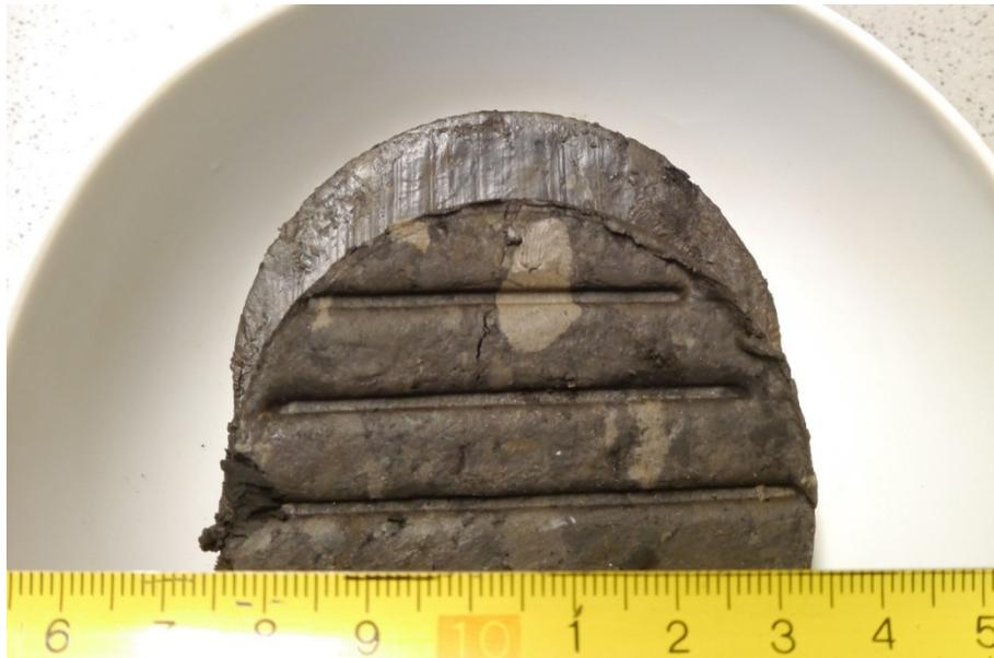
Abbildung 35: Striemung und Glättung der Scherfläche bei der Kippenprobe K1 (oberer Bildbereich)
