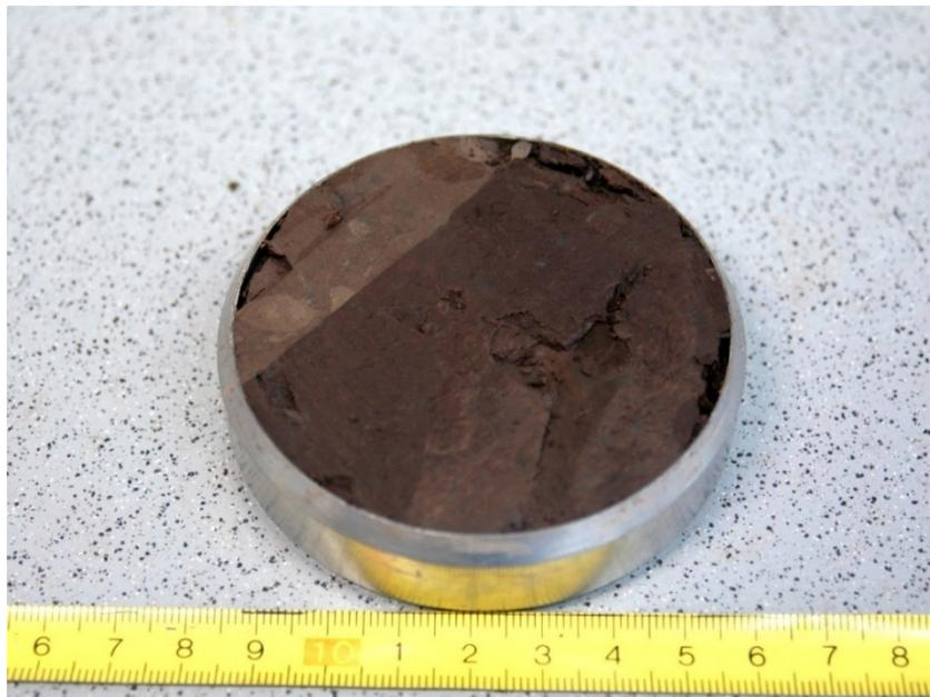
Abbildung 20: Braunkohlenton (Probe BkT1) im Schneidring mit Einbaustörungen (vor Ausbesserung). Der farbliche Absatz geht auf eine durch die Probe verlaufende Störungsfläche zurück.
