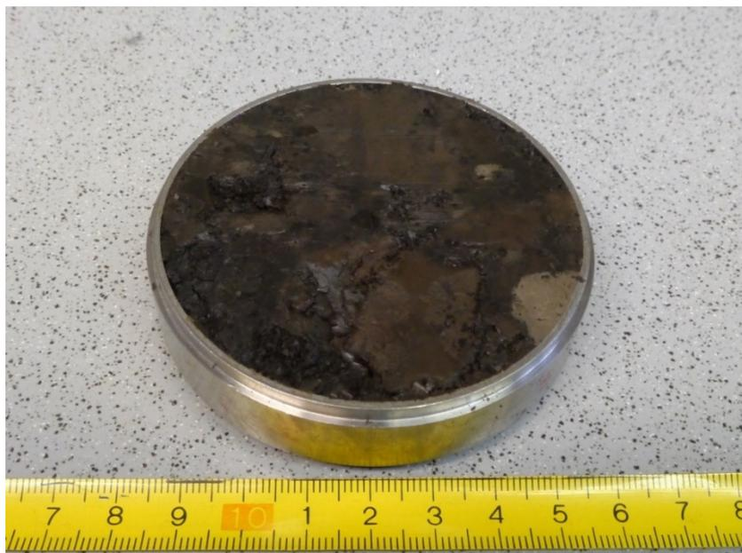
Abbildung 21: Kippe im Schneidring mit Einbaustörungen (vor Ausbesserung) und Pseudokornstruktur.
