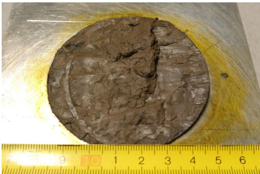
Abbildung 29: Durch Abheben des oberen, abgeschnittenen Probenteils freigelegte Scherfläche (rechter Bildbereich) beim Braunkohlenton (Probe BkT1), gewellt und mit Striemung und Glättung
